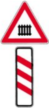
dreistreifige Bake dreistreifige Bake (links) - vor beschränktem Bahnübergang -
